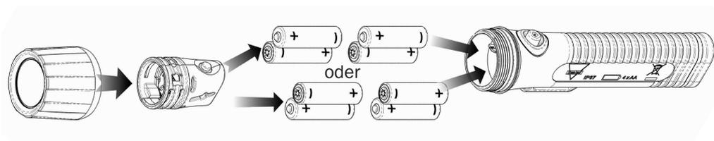
Bild 4: Explosionszeichnung PetaLux Typ 4910... mit Batterien
