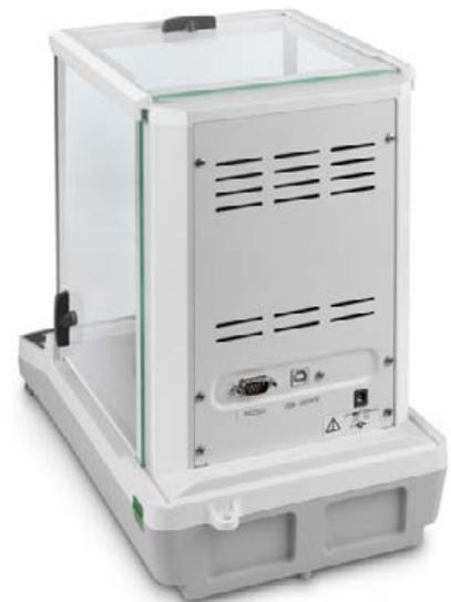
**KERN ACS/ACJ** con standard Interfaccia dati RS-232 e USB
