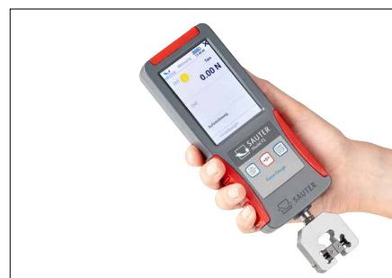
Dynamomètre compact avec cellule de mesure interne (jusqu'à 500 N max.) pour les mesures de force rapides et mobiles. L'illustration montre un accessoire optionnel, la pince à vis SAUTER AE 500
