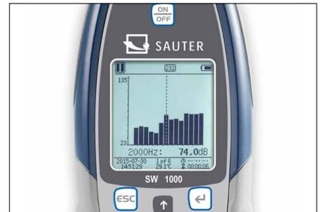
Verschiedene Schalldruckpegel wählbar, wie z. B. Laeq, LcPeak, LaF, LaFMax, LaFMin, SD, SEL, E
