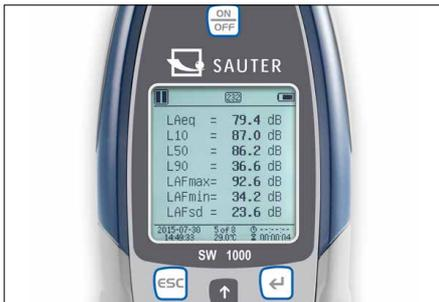
Data-Logging-Funktion mit Datum und Uhrzeit im Gerät...
