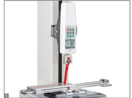
Embout universel pour bancs d'essai pour des essais de pelage à 90 degrés
